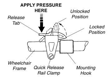
FIGURE 2 - INSTALLING/USING THE QUICK RELEASE RAIL CLAMP
